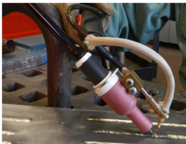
Slika 1: Gorilnik za postopek varjenja TIP TIG
