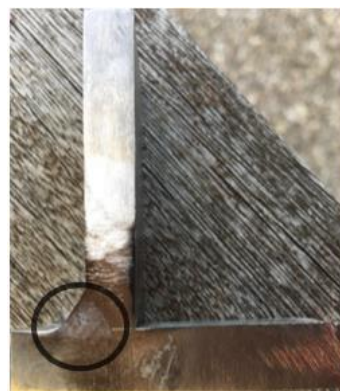
Slika 6: TIP TIG HDMT Focus: Kotni zvar brez predhodne priprave zvarnega spoja. Debelina pločevine 8 mm + 10 mm.
