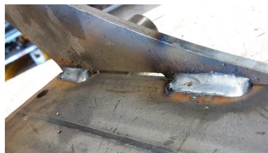
Slika 4: Varjenje z zaščitnim plinom Ar + 18% CO 2
