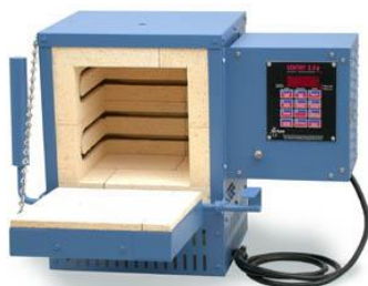
Slika 5: Toplotna obdelava za pripravo vzorcev z grobozrnato mikrostrukuro v laboratorijski peči
