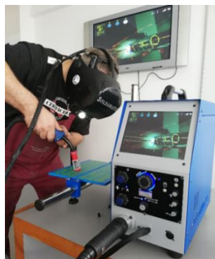
Slika 1: Uporaba simulatorja varjenja
