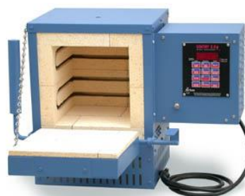
Slika 6: Toplotna obdelava za pripravo vzorcev z drobnozrnato mikrostrukuro v laboratorijski peči
