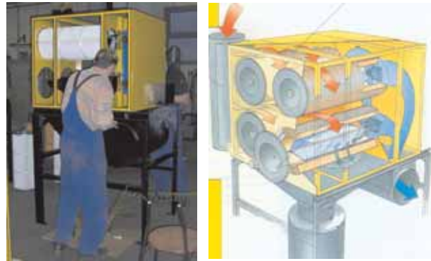
Slika. Varstoj priporoča uporabo odsesovalno-filterskih naprav serije AIR-ECO tipa MDB proizvajalca Varstoj-PlymoVent, ki so modullo grajeni sistemi z veliko kapaciteto odsesovanja (od 3.000 m 3 /h do 12.000 m 3 /h - odvisno od velikosti naprave in vgrajenega ventilatorja). Te naprave imajo vgrajene tipske filterske vložke-patrone visoke kvalitete (razred »C« po BIA oz. razred »M« po DIN EN 60335-2-69) iz poliestra, vsaka ima po 15m 2 aktivne filtrirne površine. Oblika je cilindrična (patronski filterski vložek), čiščenje je izvedeno avtomatsko s suhim stisnjenim zrakom, ki jo upravlja mikroprocesor.
